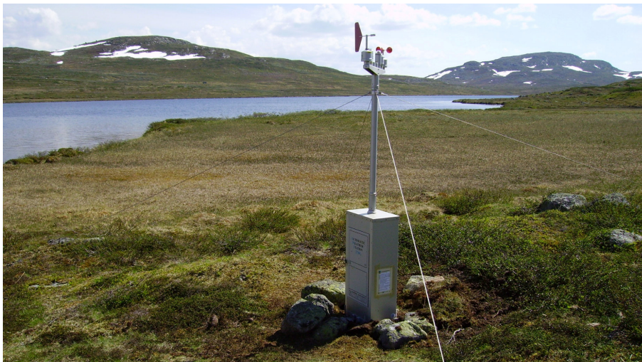
Figur 2. Værstasjonen som ble satt opp på Dargesjøen for å kalibrere værdata mot de nærmeste meteorologiske stasjonene Geilostølen og Møsstrand.
